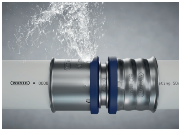
Fig. 16: DEFINED LEAK functie doet een niet-geperste fitting overvloedig lekken tijdens het afpersen.
