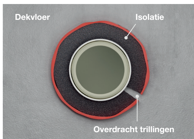
Fig 41: Overdracht mechanische trillingen via beschadigde isolatie.
