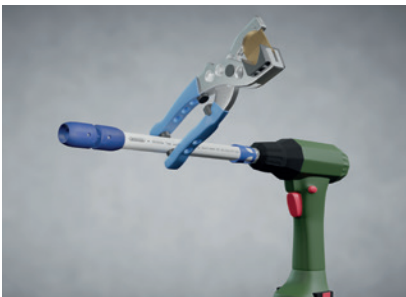
Fig. 23: Het kalibreren van de buis.
