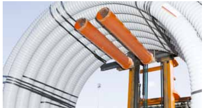
Afb. 48. Optillen met de vorkheftruck
