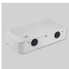
AIRSENS RF / REC.AIRSENS RF Draadloze ontvanger te plaatsen bij de WTW-unit. Tot 4 draadloze AirSens RF sensoren (CO 2 , RV of VOC) kunnen worden gekoppeld. De ontvanger geeft altijd het hoogste signaal door aan de WTW-unit.
